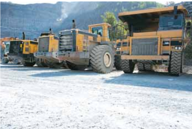
L'esame del veicolo deve essere realizzato a motore spento e freno a mano inserito
