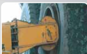
2 Spingere l'anello conico
