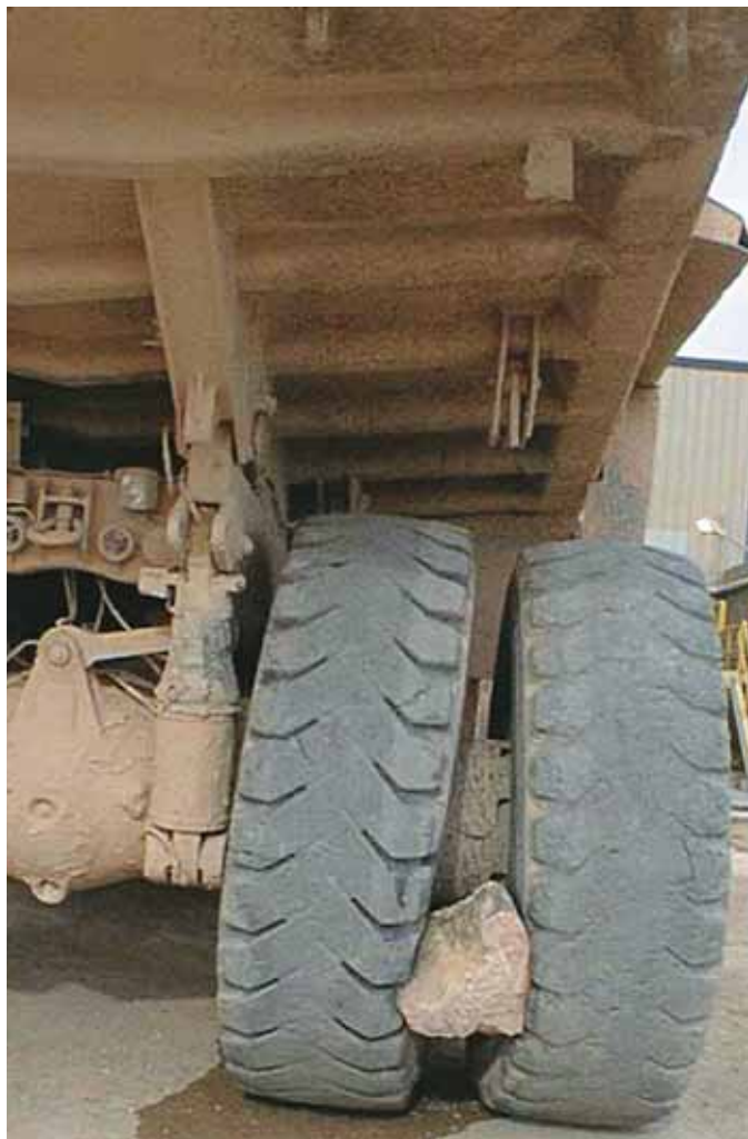
Attenzione alle proiezioni di pietre durante lo smontaggio di pneumatici gemellati!
