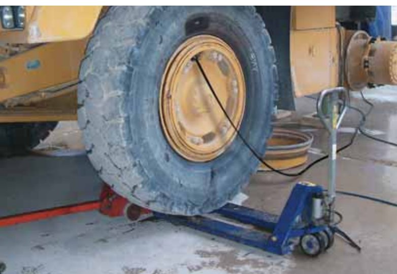
Tenersi ad almeno 6 metri dalla valvola
