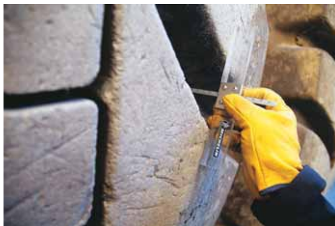
Misurare la profondità residua di scultura nelle zone previste dal fabbricante e in più punti.
