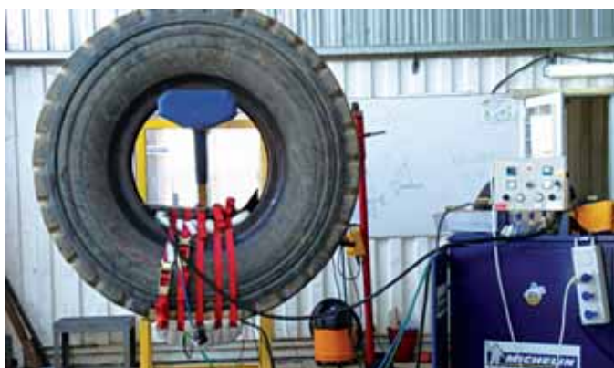
Vulcanizzazione tramite pressa settoriale
