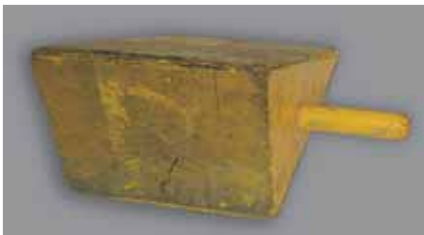
Spessore in legno dimenticato in un pneumatico al montaggio...
