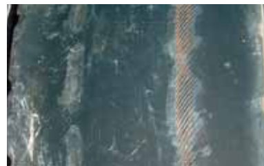
Un pneumatico troppo usato non è più ricostruibile
