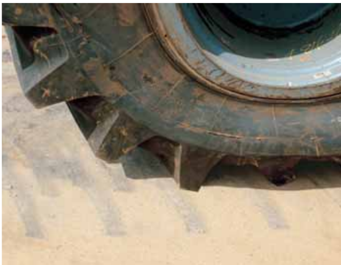
Un sotto-gonfiaggio riduce la longevità del pneumatico
