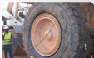
13 Gonfiare alla pressione di montaggio, poi portare alla pressione di esercizio
