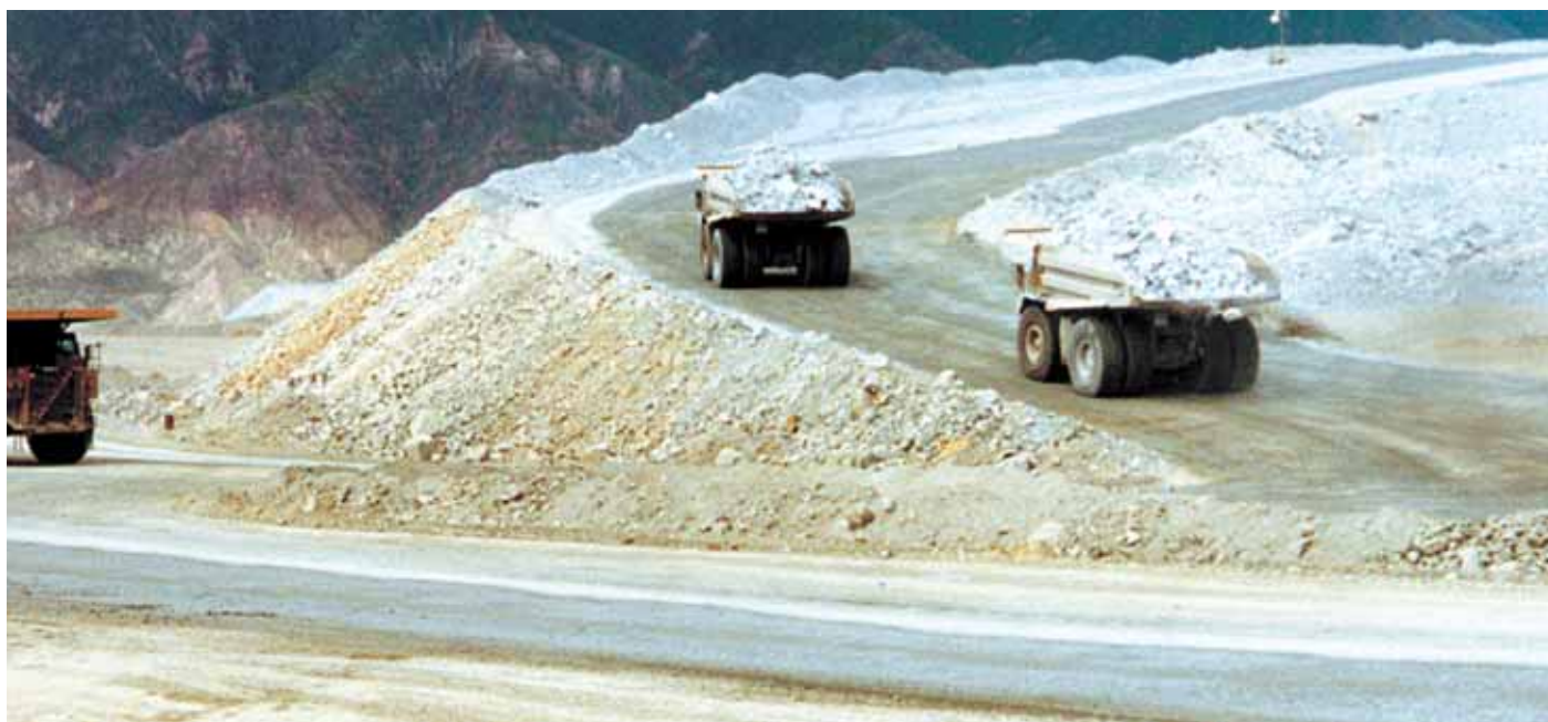
Raggio e inclinazione delle curve influiscono sulla durata dei pneumatici
