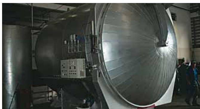
Vulcanizzazione in autoclave
