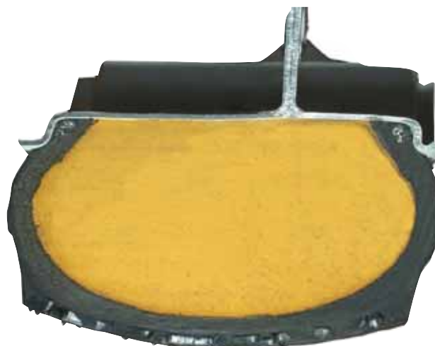
Solido di riempimento costituito da elastomeri di poliuretano
