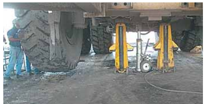
La regolazione del parallelismo va fatta preferibilmente a ruote sospese
