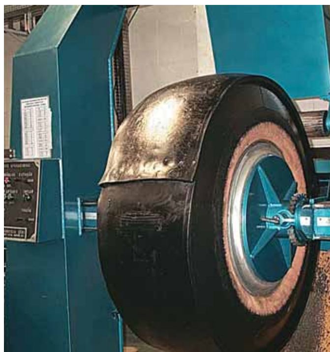
Posa di una banda calandrata
