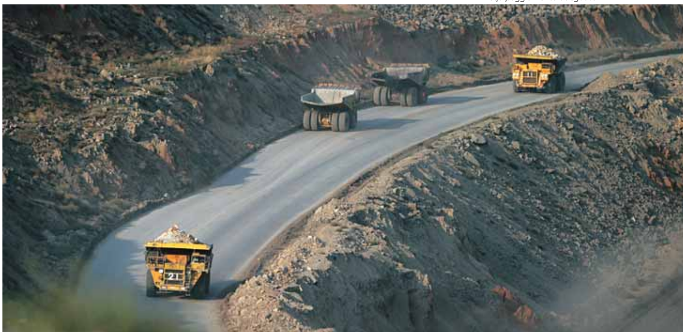
I lunghi cicli aumentano i rischi di surriscaldamento (a parità di carico e velocità)
