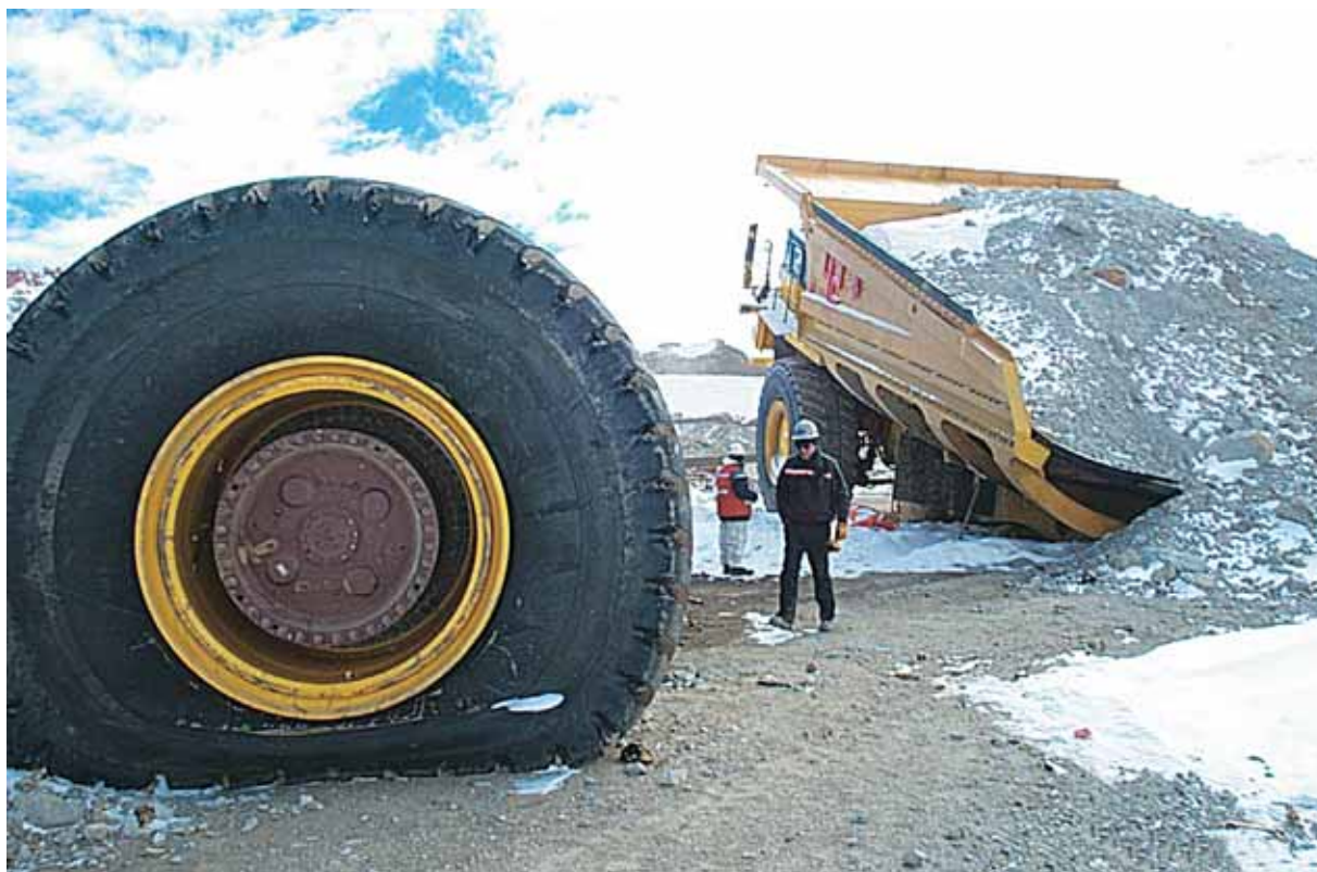
Il cedimento strutturale del pneumatico può provocare ingenti danni e coinvolgere altre parti del veicolo, oltre al pneumatico stesso.
