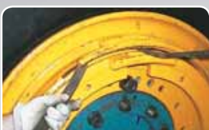
3 Estrarre l'anello di bloccaggio
