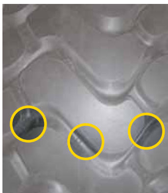
Localizzazione dei testimoni di usura su un pneumatico MICHELIN XHA2.
