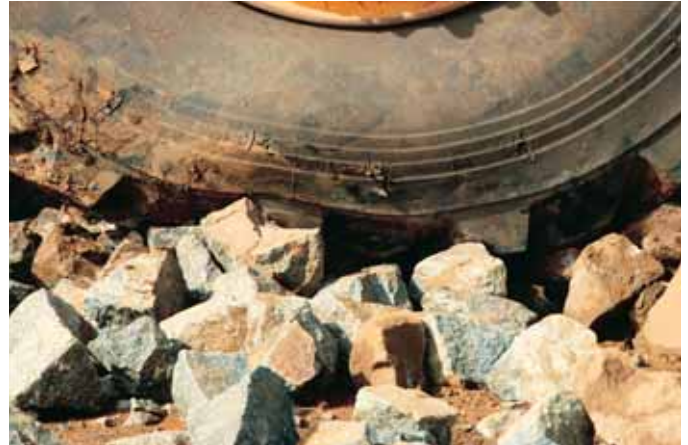
Il rotolamento su pietre diminuisce notevolmente la durata dei pneumatici
