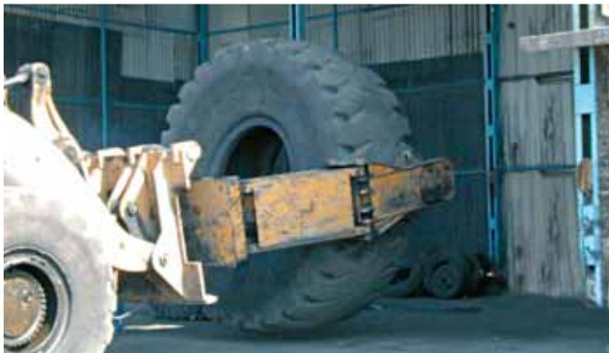
Pala caricatrice equipaggiata con pinza per pneumatici
