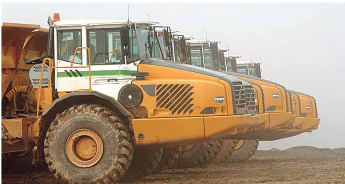
Dumper articolati allineati in cantiere
