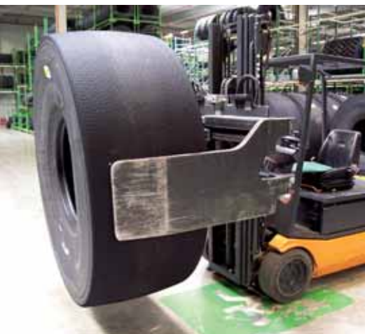
Un serraggio eccessivo può deformare il pneumatico
