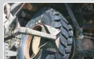
8 Posizionare il pneumatico sul cerchio
