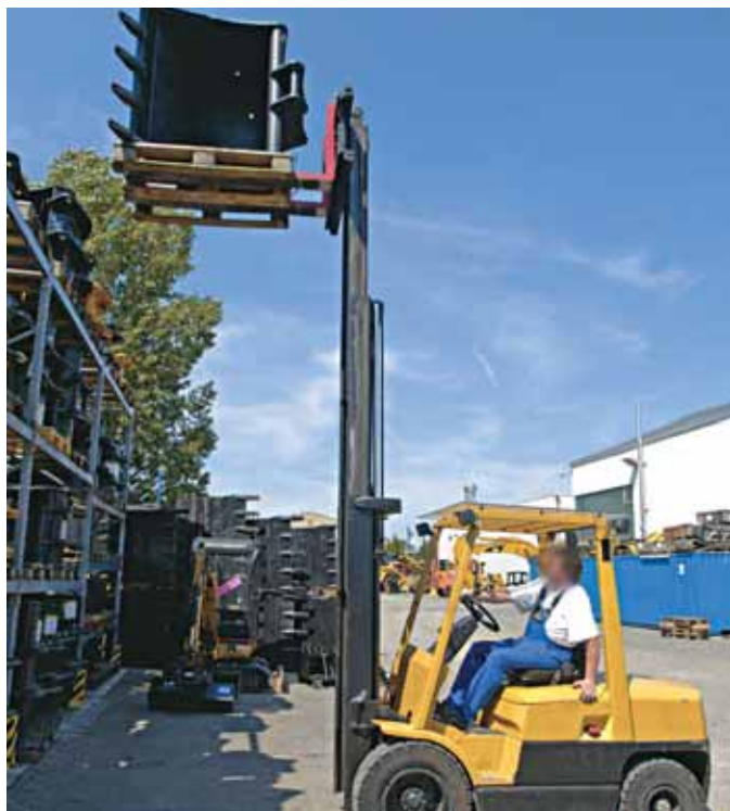
Il riempimento dei pneumatici incrementa la stabilità del veicolo.
