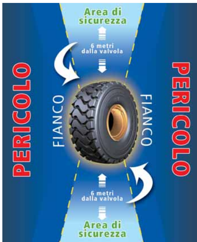
Durante il gonfiaggio, mantenersi sempre di fronte al battistrada
