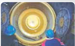
9 Spingere l'anello conico con la pinza per pneumatici
