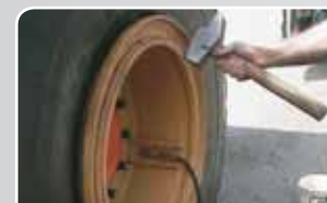
12 Gonfiare e picchiare leggermente sull'anello di bloccaggio
