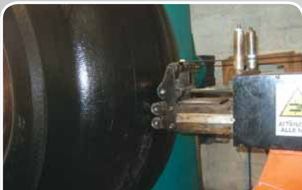
Rivestimento con banda stratificata
