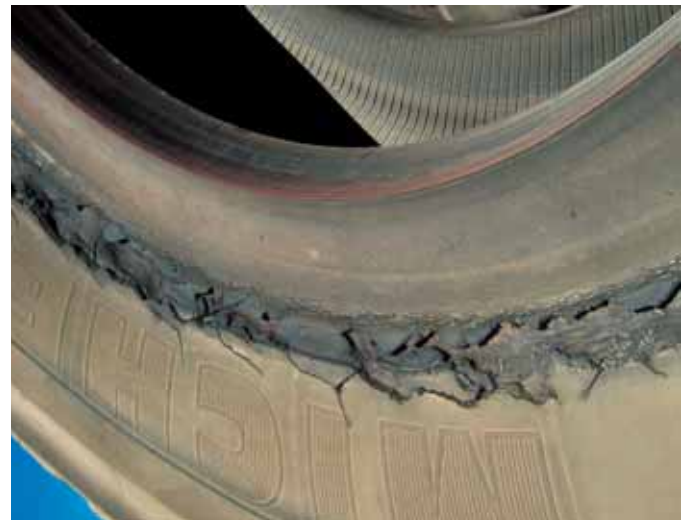
Danneggiamento al tallone dovuto al sovraccarico del veicolo
