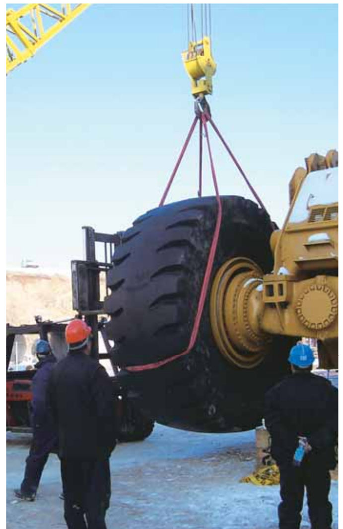
Verificare sistematicamente lo stato delle cinghie prima dell'utilizzo!
