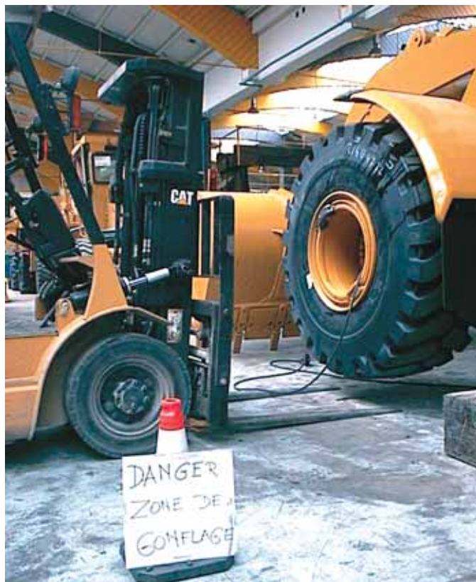
Gonfiaggio in posizione verticale, dintorni protetti in caso di proiezione delle parti mobili
