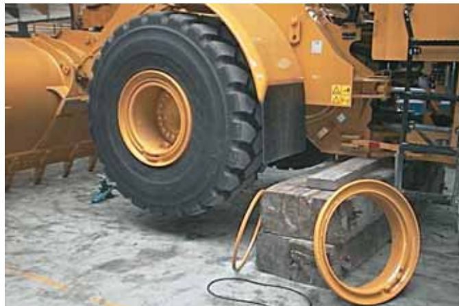
Immobilizzazione di una pala caricatrice.
