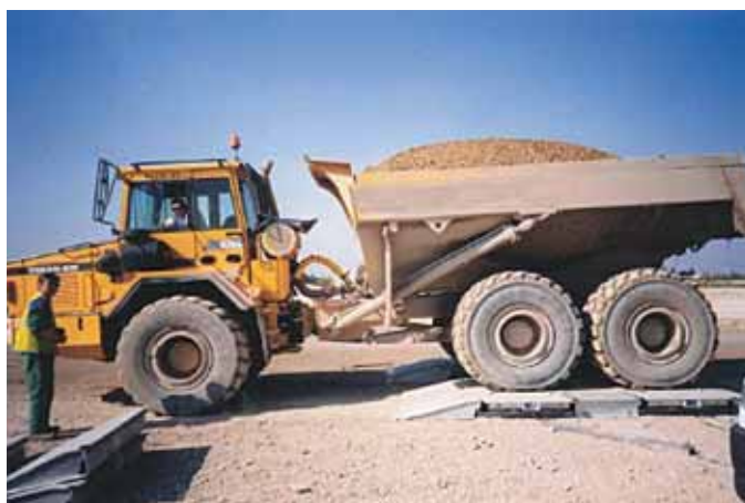
Pesate degli assali posteriori di un dumper articolato
