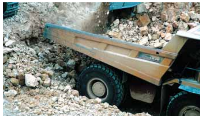
La presenza di pietre aumenta il rischio di strappi al battistrada
