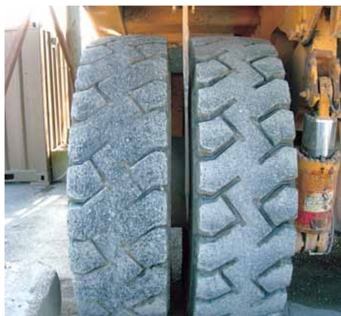
Su un asse gemellato, non montare pneumatici con usure differenti
