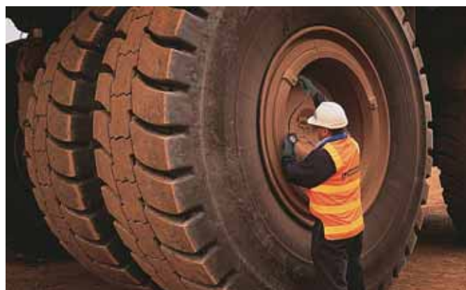
Prima di procedere al controllo della pressione, pulire la valvola
