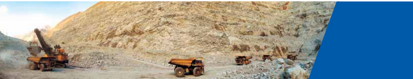
La regolare manutenzione delle aeree di carico influisce positivamente sulla durata dei pneumatici
