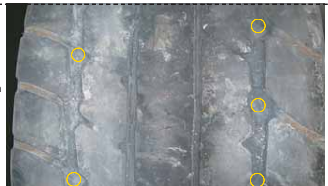
MICHELIN X-CRANE con i ponticelli delle spalle e i canali longitudinali centrali riscolpiti (ponticelli centrali e canali longitudinali esterni non riscolpiti)
