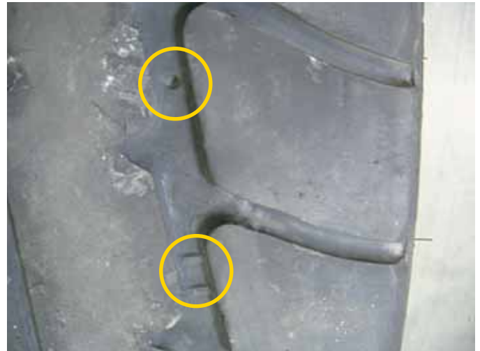
MICHELIN X-CRANE: pozzetto indicante il limite di riscolpitura (in alto), testimone di usura (in basso)
