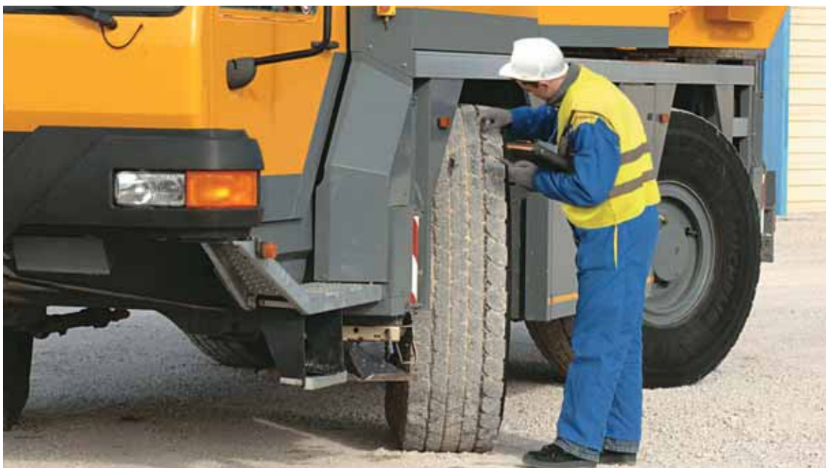
Iniziare con la ruota anteriore sinistra poi fare il giro del veicolo in senso orario
