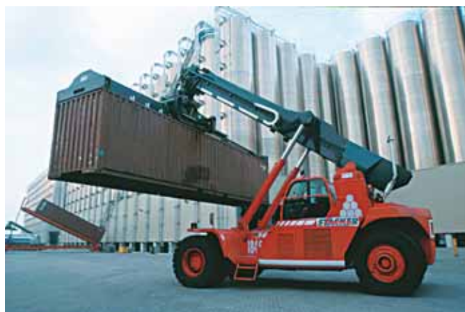
Sui reach stackers le ruote direttrici (posteriori) sono le più sollecitate, anche col carico
