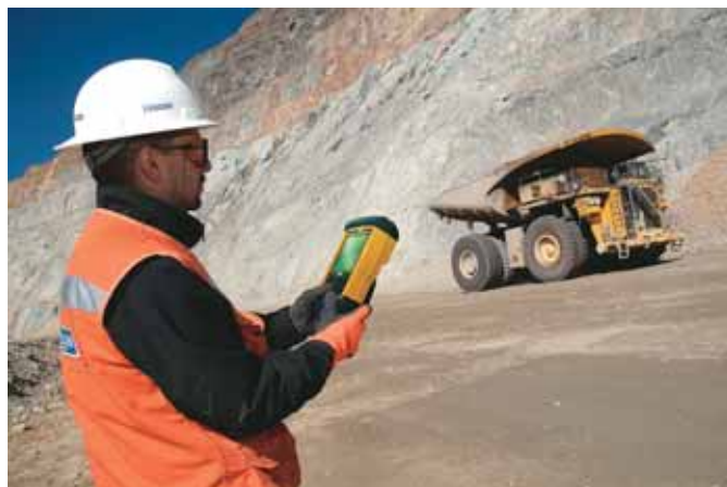
Con il sistema MEMS, è possibile verificare la pressione dei pneumatici a distanza senza dover fermare il veicolo.
