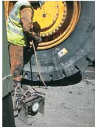
Serrare i dadi seguendo le istruzioni del costruttore del veicolo
