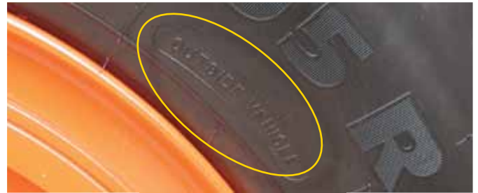
Montaggio del pneumatico con marcaggio "Outside vehicle" ben visibile
