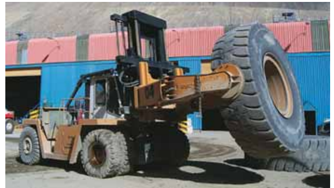
Carrello elevatore equipaggiato con pinza per pneumatici
