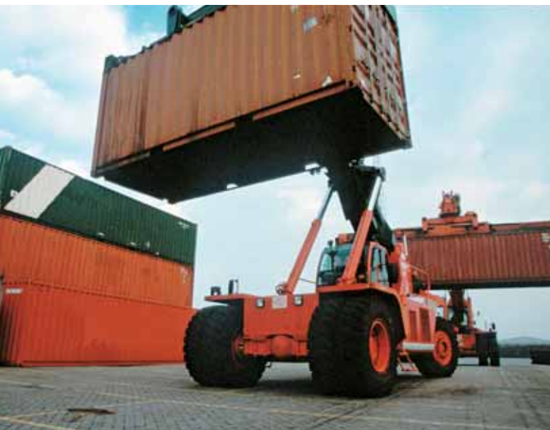
L'equipaggiamento in gemellato è utilizzato per veicoli che portano carichi pesanti
