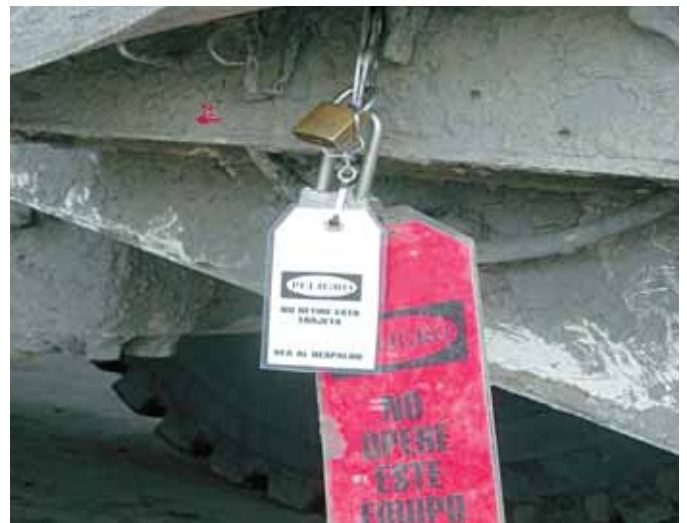
Se esiste, inserire il blocco di sicurezza
