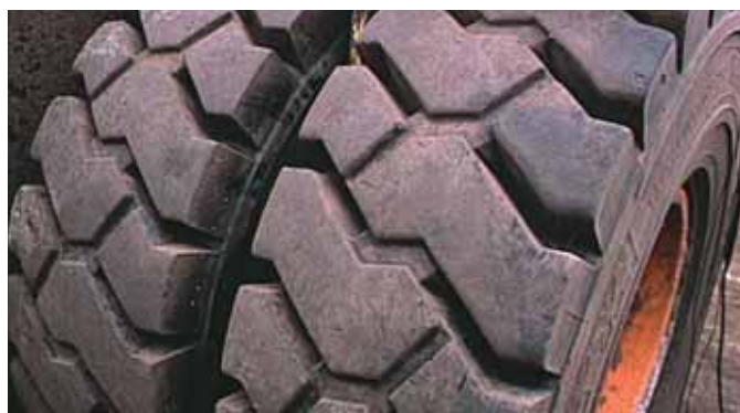
Pneumatici MICHELIN XZM montati in gemellato
