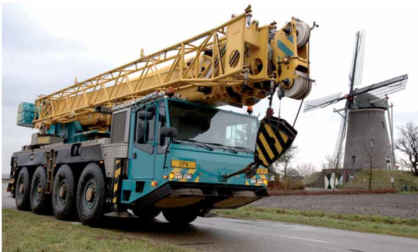
Gru automotrice equipaggiata con pneumatici MICHELIN X-CRANE
