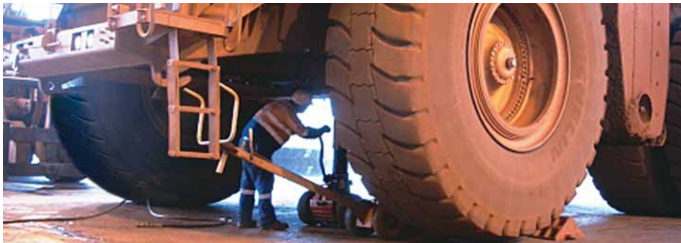
Per regolare le sospensioni è indispensabile posizionare degli spessori sotto il veicolo
