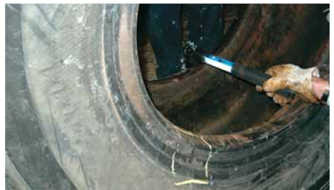
Esame dell'interno del pneumatico, una verifica indispensabile
