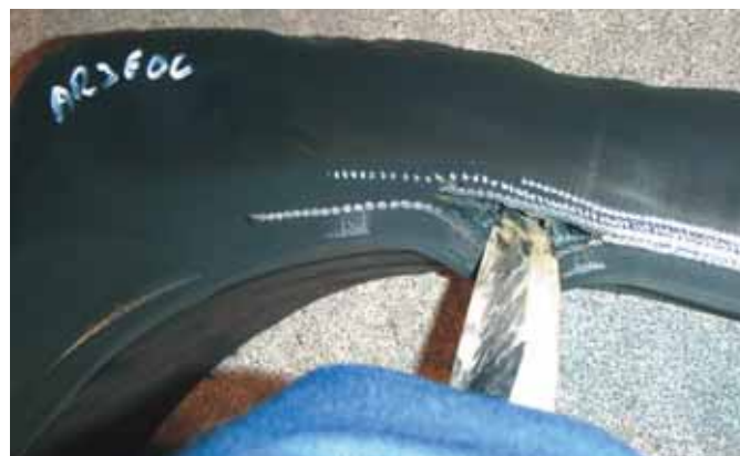
Separazione dei componenti di un pneumatico
