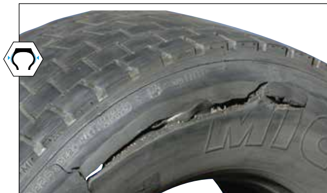
Rottura circonferenziale dei cavi della della carcassa sui fianchi
